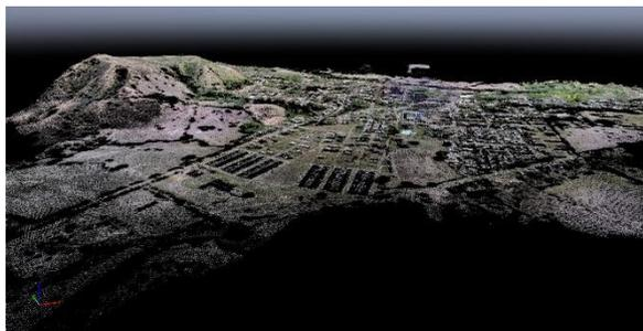
Figura 2 Nube de puntos, formato LAS del Municipio de Tarqui - Huila. Elaboración Propia Software Pix4 d.
