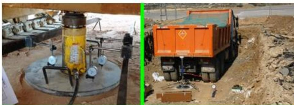
**Figura 1.** Ensayo de carga con placa para la medida del módulo de reacción
