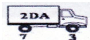
**Imagen 5.** Camión de 2 ejes simples y 4 ruedas con su capacidad de carga según el MTOP.
